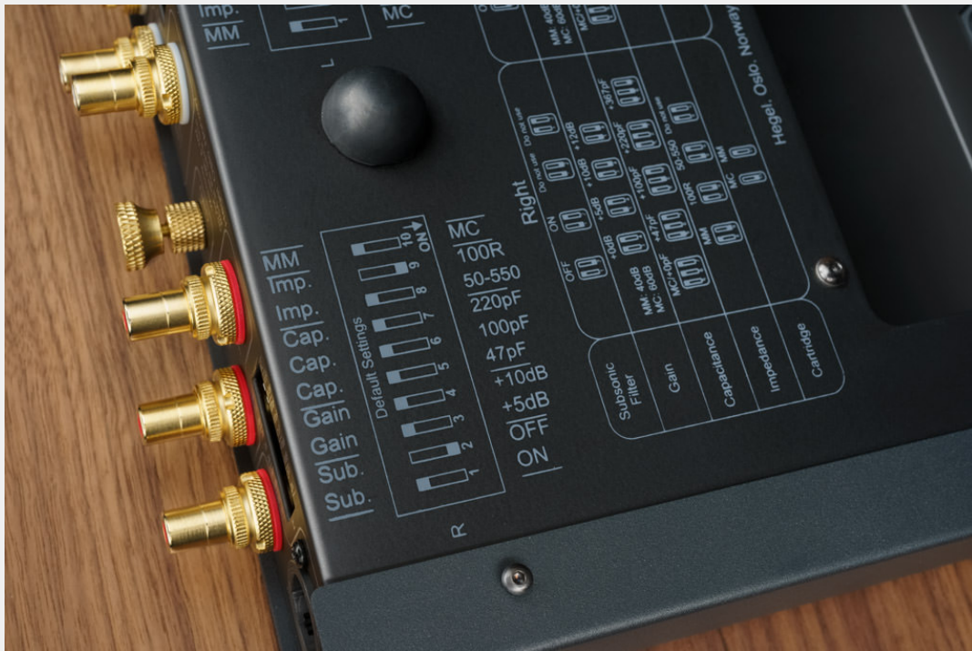
Die Zuständigkeiten der einzelnen Mäuseklavier-Schalter und die Auswirkung ihrer Betätigung ist ebenfalls bodenseitig illustriert.
