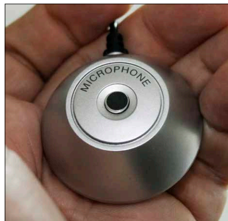
Das beiliegende Präzisionsmikrophon dient der Einmessung der Dirac-Live-Raumkorrektur.
