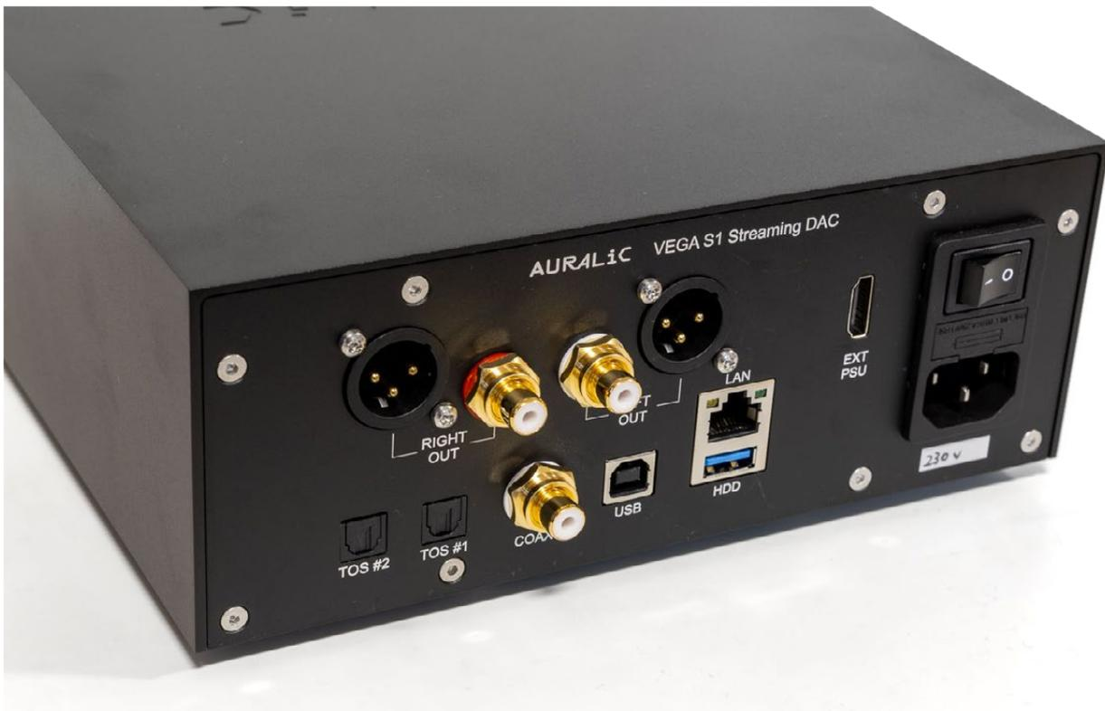
Vier digitale Eingänge plus USB für HDD und Analogausgänge als Cinch und XLR. Die HDMI-Buchse dient zum Anschluss des optionalen Netzteils (Foto: F. Borowski)
