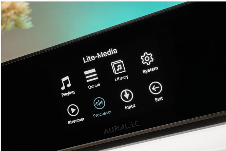
Dem stabilen Aluminiumgehäuse steht die verglaste Front mit zentralem Farbdisplay vor. Auch wenn es den Anschein macht, handelt es sich dabei nicht um einen Touchscreen. Die Bedienung erfolgt mit den Tasten auf der Oberseite, oder per App.
