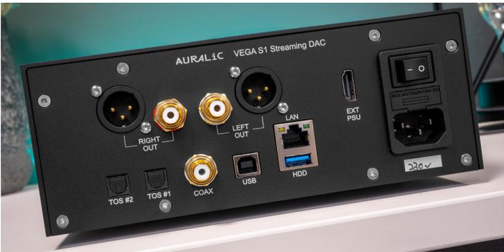
Per HDMI kann das externe Purer-Power Netzteil verwendet werden. Als Singaleingänge stehen USB-B, S/PDIF- und Toslink-Verbindungen bereit.
